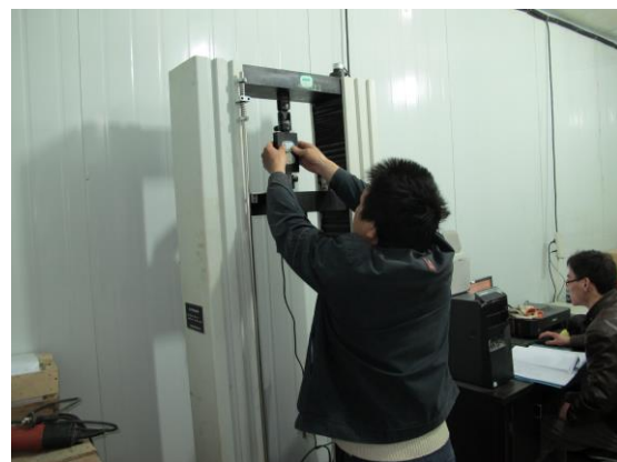
PSI®-5 系浆材力学性能检测
