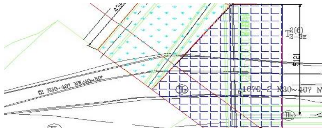
1670 层 4#固结灌浆段 f_2 断层及层间挤压错动带平面图
