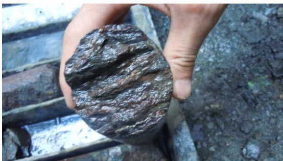
f_2 断层芯样照片
