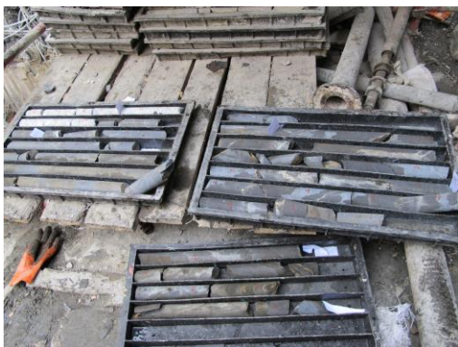
f_2 断层芯样照片
