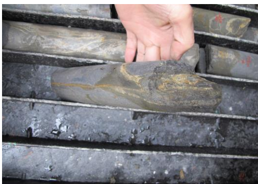
f_2 断层芯样照片
